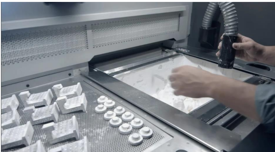
Figura 13. Extracción y limpieza de piezas en una impresora 3D SLS. Fuente: https://i.all3dp.com/cdn-cgi/image/fit=cover,w=1284,h=722,gravity=0.5x0.5,format=auto/wp-
