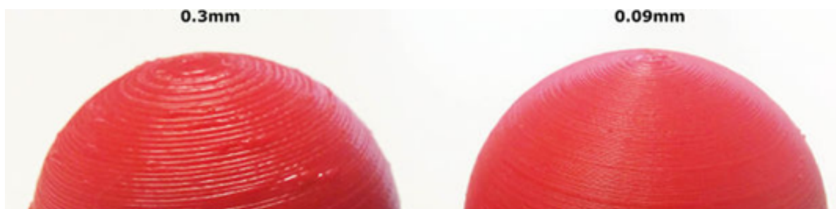
Figura 22. Differenze visive in base a diverse altezze di livello. Fonte: http://wiki.ikaslab.org/images/thumb/8/8c/Altura_de_capa.jpg/700px-Altura_de_capa.jpg
