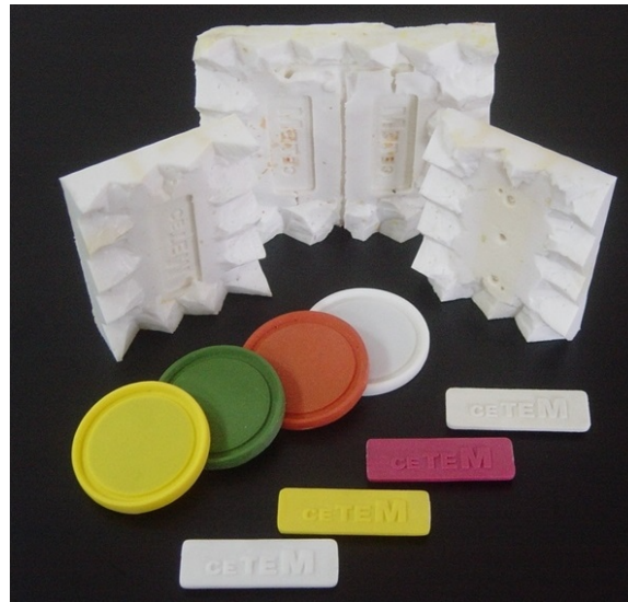
Figura 2. Stampo in silicone e pezzi creati con tecniche di prototipazione rapida. Fonte: CETEM.
