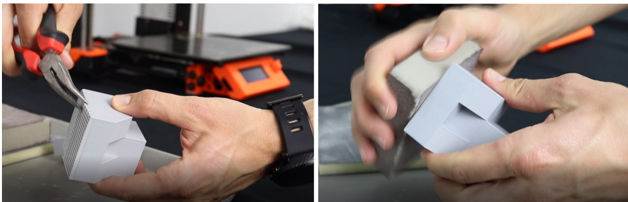
Figura 25. Rimozione di strutture di supporto da un pezzo FDM con pinze e levigatura della superficie. Fonte: CETEM.
